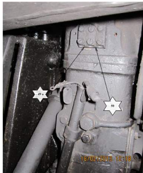
Fig.6 Instalația de antipatinaj de pe regulatorul mecanic
