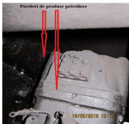
Fig.5 – Motorul diesel cu pierderi de ulei și motorină
