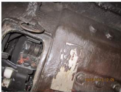
Fig.9 Starea de curățenie a motoarelor de tracțiune
